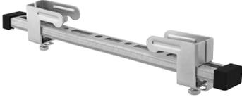
Les Accroches Tout BCL permettent de réaliser du supportage sans perçage ni soudure sur fer IPN de 2 mm à 20 mm. Ils peuvent être associés à de la tige filetée M6-M8-M10, filin, chaînette, colliers de tuyauterie, ventilation et conduit électrique. Livrés avec 2 bouchons de finitions noirs.
