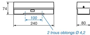
Bloc équipé d'une lampe de vieille à Led.
