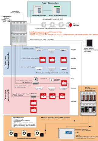
Idéal pour les installations de détection incendie de taille petite à moyenne, l'équipement de Contrôle et de Signalisation TSM Evolution est disponible en versions pré-équipées permettant, selon le modèle, de gérer 256 périphériques de détection, une zone d'évacuation et une zone de mise en sécurité.
