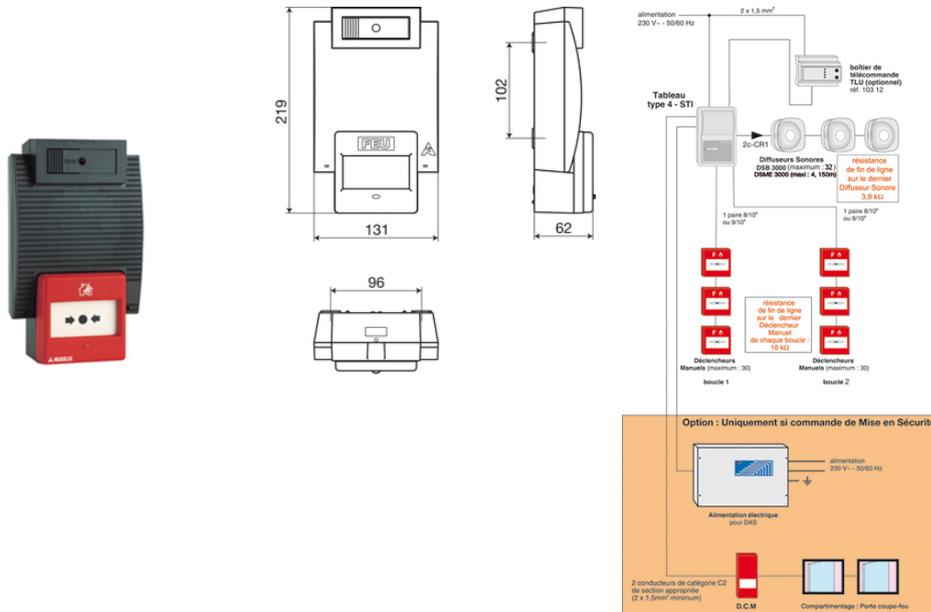
Adapté pour les Établissements Recevant du Public (ERP) ou les Établissements industriels nécessitant un Equipement d'Alarme de type 4.
