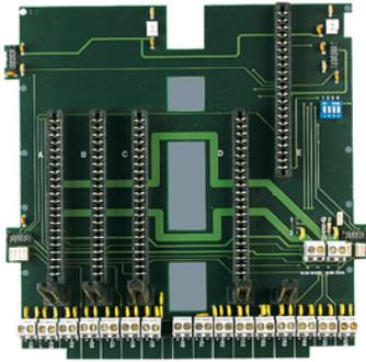
La centrale CMSI est composée, dans sa configuration de base, d'un boîtier équipé d'une alimentation électrique NF EN 54-4 et de la carte fonction/gestion/afficheur permettant la programmation et l'exploitation du système.
