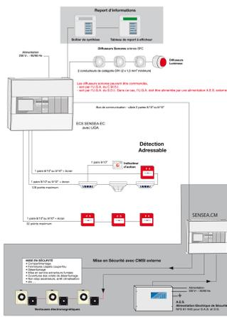
L'Équipement de Contrôle et de signalisation Sensea.EC a été conçu spécifiquement pour les bâtiments de taille moyenne à importante nécessitant un système de Détection Incendie Adressable.
